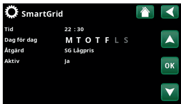
SmartGrid-funktionen "SG Lågpris" schemaläggs vardagar kl. 22.30-06.00. Gå till menyn genom att välja "SmartGrid veckoschema" i meny "Avancerat/Inställningar".
