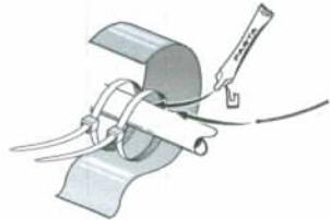
Temperaturgivarna monteras med buntband tillsammans med värmceledningspasta och aluminiumtejp. Därefter skall de isoleras med medföljande isolertejp.
